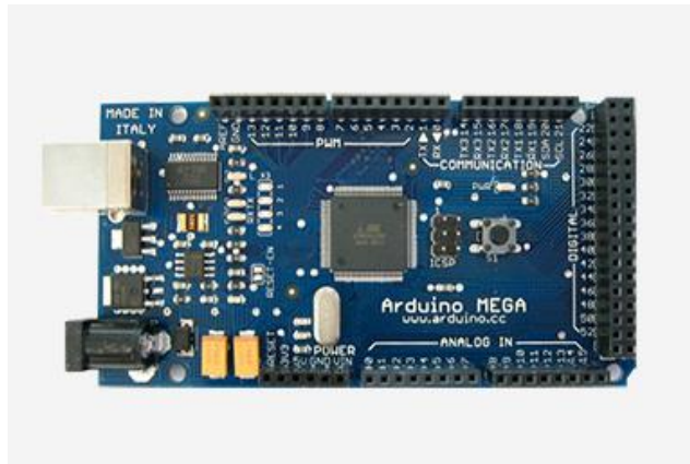
Figura # 19 Tarjeta Arduino Mega (Arduino, 2018)
